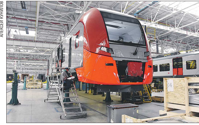
1,5 тонны весит знаменитая красная фронтальная маска «Ласточки» с надписью «РЖД». К кузову она не приваривается, а приклеивается высокоточным эластичным клеем
