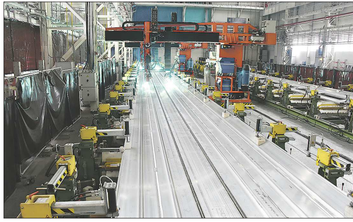
Крупные элементы вагона электропоезда «Ласточка» (панели, крышу и пр.) соединяет роботизированный сварочный комплекс немецкого производства
