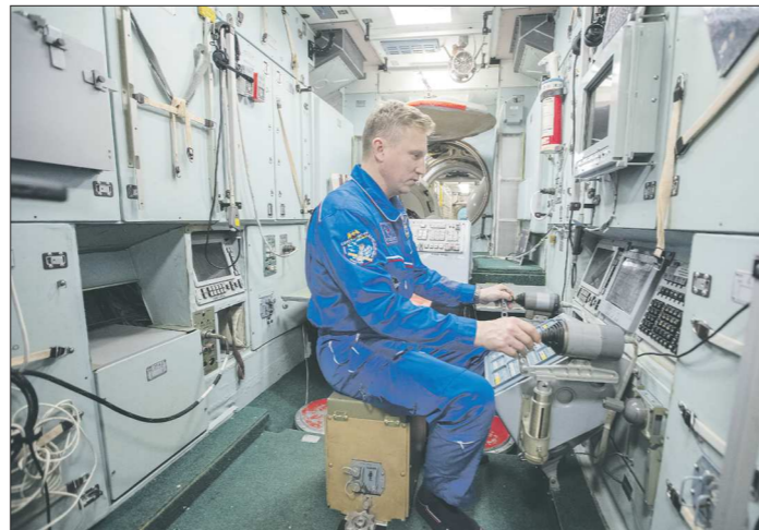
Сергей Прокопьев показывает, как космонавты вручную управляют стыковкой грузового корабля с борта МКС
