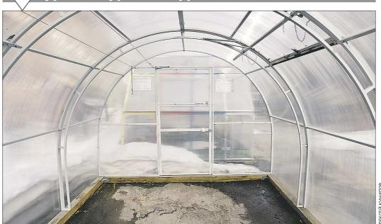
Арочная с двойными дугами, расположенными одна под другой - это один из наиболее прочных вариантов теплицы из металлических конструкций под сотовый поликарбонат. Такую теплицу часто называют фермерской. А есть и другие варианты металлических теплиц - в форме капельки, домиком, по Миттлайдеру...
