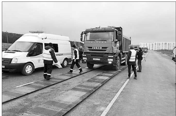
Комиссионные контрольные взвешивания на автоматических пунктах весогабаритного контроля (25 октября, г. Нижний Тагил)
