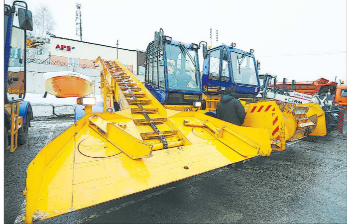
Этот снегопогрузчик полностью наполняет самосвал снегом за три минуты
