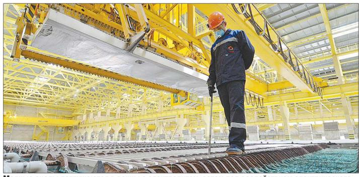
Медные аноды погружаются в ванны с электролитом, затем под воздействием электрического тока медь в виде ионов оседает на нержавеющей катоды. Чтобы вовремя выявить и прекратить короткое замыкание, по верху ванны несколько раз в день проводится обход
