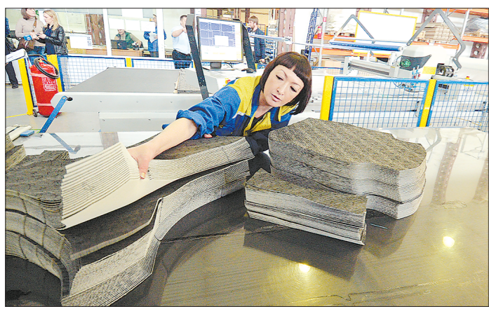
Новый станок на предприятии «Сибeko» может кроить для автосидений до сорока слоёв ткани разом. Для этого материал спрессовывается вакуумом и режется специальным ножом
