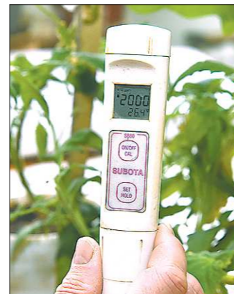
Кондуктометр быстро поможет определить степень минерализации грунта
