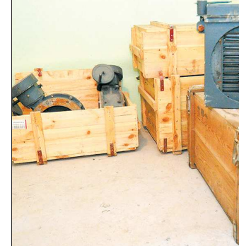
Заспаса противозрывной воздушный клапан. При сильной взрывной волне створки закрываются, а потом открываются
