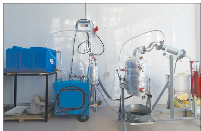
Опытная установка паровой дистилляции позволяет за час получить около пяти миллилитров эфирного масла
