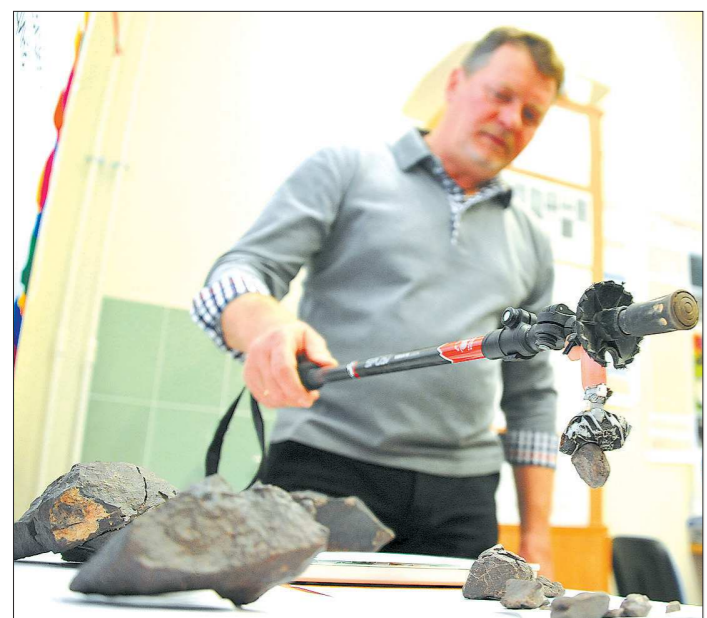
Металлоискатель, который свердловчане собрали своими руками из лыжной палки и магнита, работает безотказно
