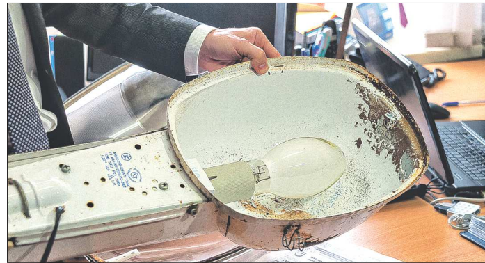
Старые металлические светильники быстро портятся и требовали в 2,5 раза больше энергии
