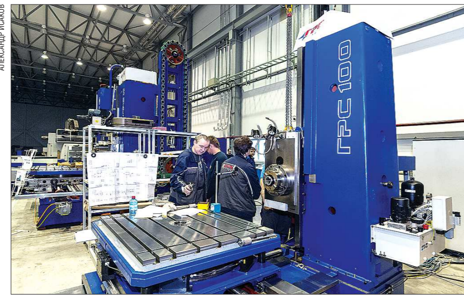
Уловая сборка одного станка занимает у рабочих «ГРС Урал» от четырёх до 14 месяцев, в зависимости от модели машины
