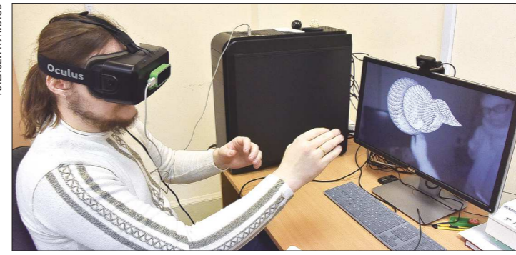
Управлять роботами при помощи взмаха руки? Легко! Илья Стародубцев , главный программист отдела системного обеспечения сектора компьютерной визуализации Института математики и механики УрО РАН, создал специальную программу – жестовый интерфейс. Такие технологии могут использоваться при управлении производственными роботизированными машинами, военными летательными аппаратами и медицинским оборудованием
