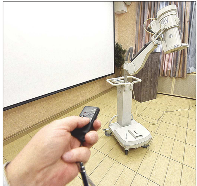
Теперь сделать рентгеновский снимок можно прямо в палате благодаря мобильному рентгеновскому аппарату, который создали учёные из Института электрофизики УрО РАН. Устройство работает на небольшом импульсном генераторе, что позволяет снизить дозу облучения, сохранив при этом качество снимка. Сегодня такие аппараты уже есть в госпитале ветеранов войн в Екатеринбурге, а также в различных медицинских учреждениях в Астрахани, Казани и Санкт-Петербурге
