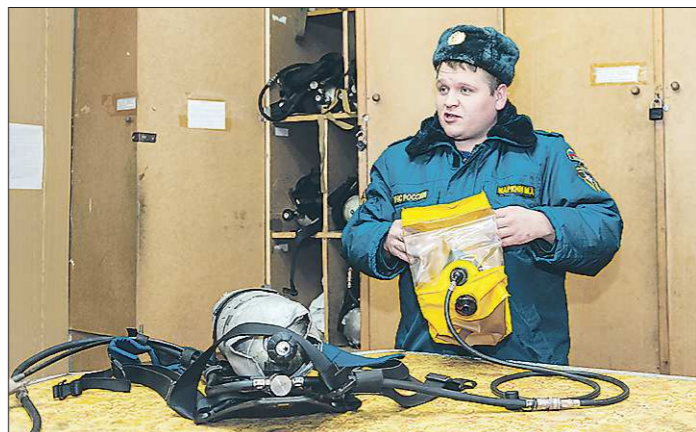
Максим Маркин показывает спасательное устройство — к баллону с кислородом присоединены две маски: одна для пожарного, вторая — для пострадавшего
