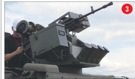
**3** **Дистанционно управляемый боевой комплекс «Арбалет-ДМ» на базе броневедомоля «Тигра». Разработчик и производитель — Ковровский электромеханический завод и компания «Оружейные мастерские».**
