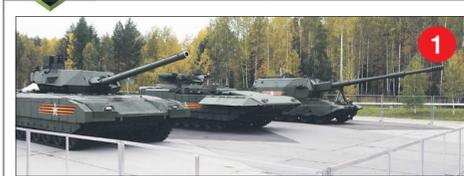
**1** **Танк Т-14 на базе новой платформы боевых гусеничных машин «Амат». Разработчик и производитель — корпорация «УВЗ».**
