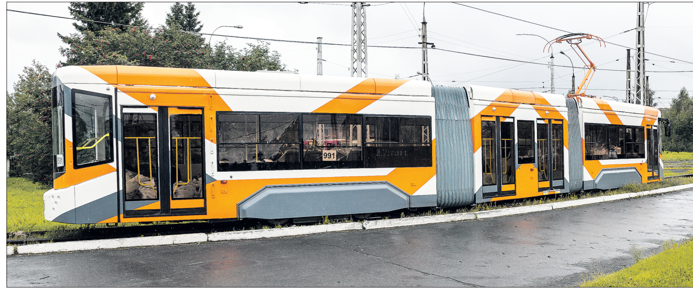
Новый трёхсекционный трамвай Уралтрансмашина имеет длину 21,9 метра и способен одновременно перевозить 205 пассажиров, то есть в два с лишним раза больше, чем наиболее распространённый сейчас на наших линиях чешский трамвай «Татра Т3» (95 человек)
