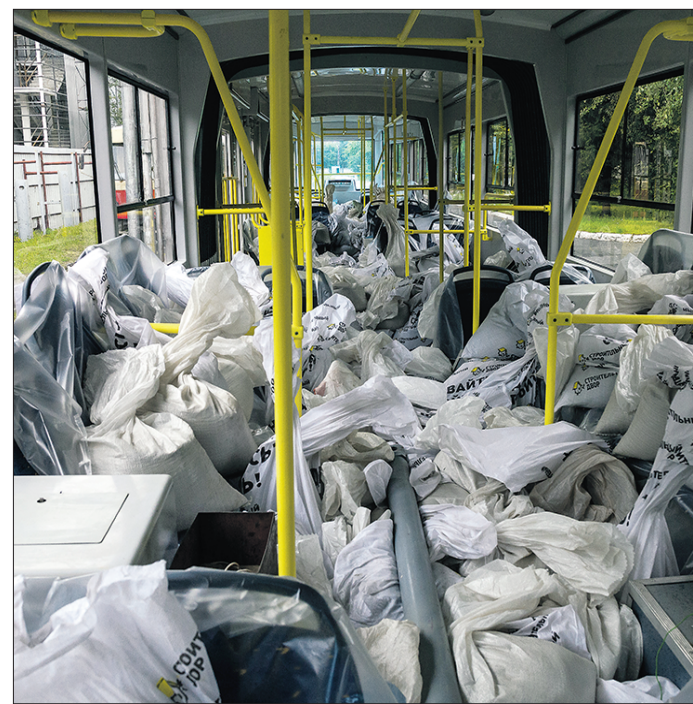
Максимальная грузоподъёмность трамвая — 14 тонн
