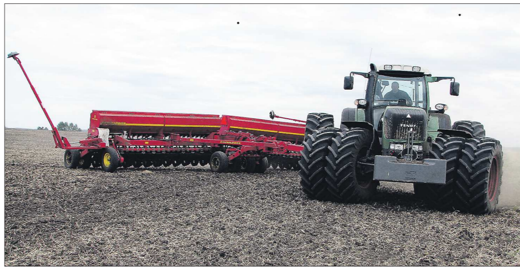
Спаренные колёса трактора не только придают ему брутальность, они ещё снижают удельное давление на почву, повышают проходимость агрегата на влажном поле
