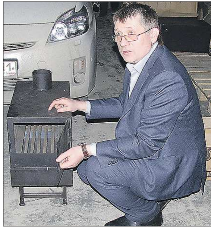
Дмитрий Вершинин показывает буржуйку для Луганска. Она хоть и проста на вид, но сделана с колосниками и поддувалом, значит, не только дрова будут в ней хорошо гореть, но и украинский уголь. А если обложить такую буржуйку кирпичом, то и тепло будет храниться дольше
