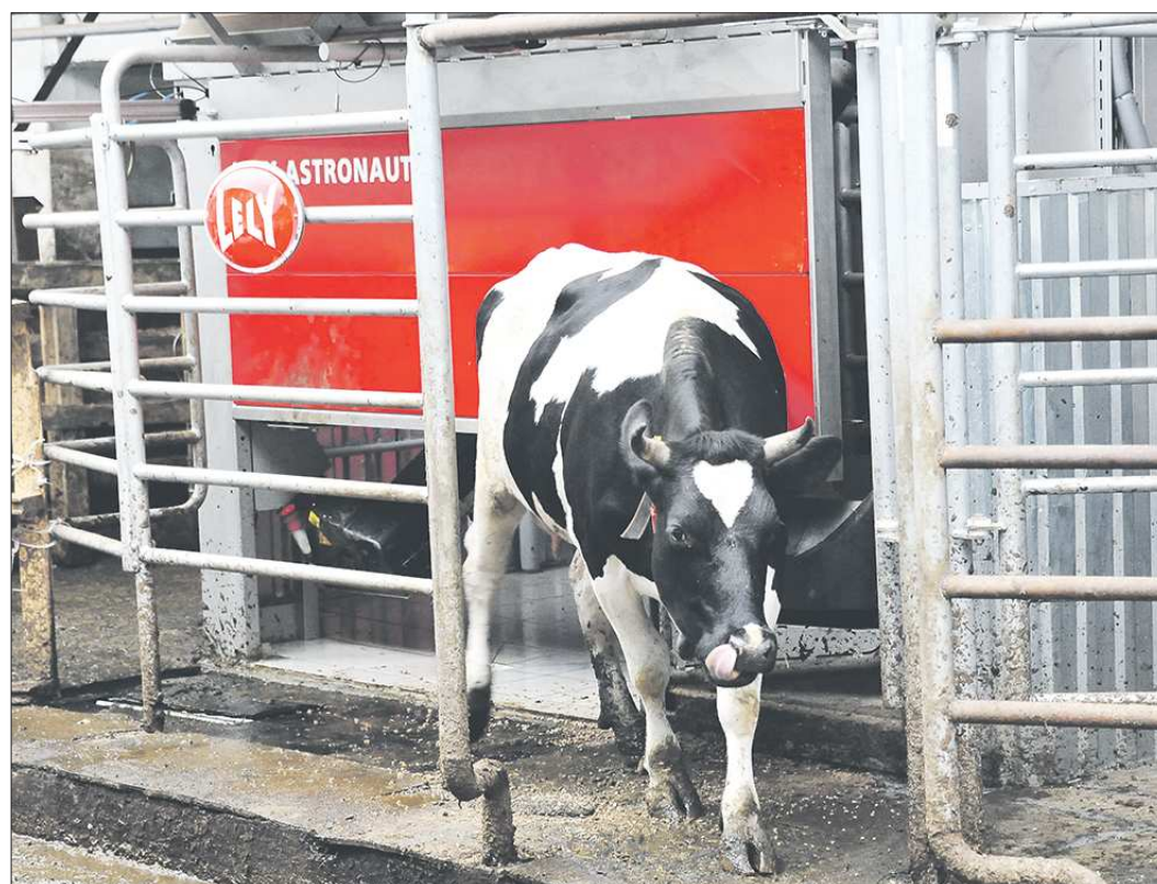
Первая в Свердловской области роботизированная система доения заработала в августе этого года в СПК «Глинский» Режевского городского округа. Внешне она больше похожа на загончик, внутри которого спрятались инфракрасные датчики и манипулятор. Робот сам присоединяет к вымени коровы доильную систему, весь процесс происходит без участия человека
