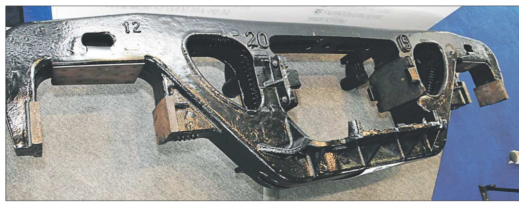
Боковая рама вагонной тележки из ванадий-титаносодержащей стали повысит безопасность подвижного состава РЖД
