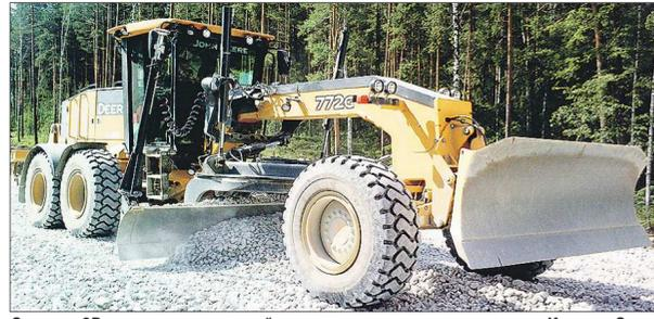
Система 3D-нивелирования в действии — при строительстве дороги Исеть — Сагра. Состоит из базовой станции (она может находиться в пяти километрах от места работ, внешне — как нивелир на штативе), антенны и трёх датчиков, которые крепятся к отвалу грейдера и регулируют его положение, приёмника (он в кабине) и бортового компьютера (на фото справа). Кстати, надпись «Вне проекта» в правом верхнем углу компьютера говорит о том, что грейдер ушёл с маршрута, и смещение составляет целых 13 сантиметров
