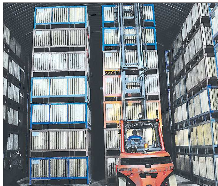
Такому объекту требуется специальный погрузчик и крепкий бетонный пол
