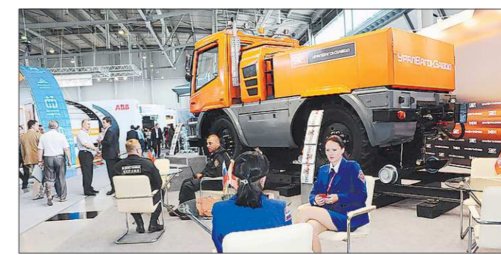
Такой тепловоз в считанные минуты переоборудуется в колёсный тягач
