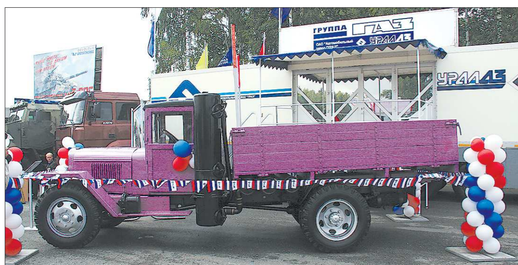
А ещё в середине прошлого века дровяные генераторы устанавливались на автомобили, автобусы, трактора и даже мотоциклы. На снимке серийный автомобиль ГАЗ-42
