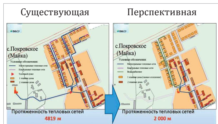
По перспективной схеме почти три километра труб станут лишними в этом селе. Причём без ущерба для теплоснабжения населения
