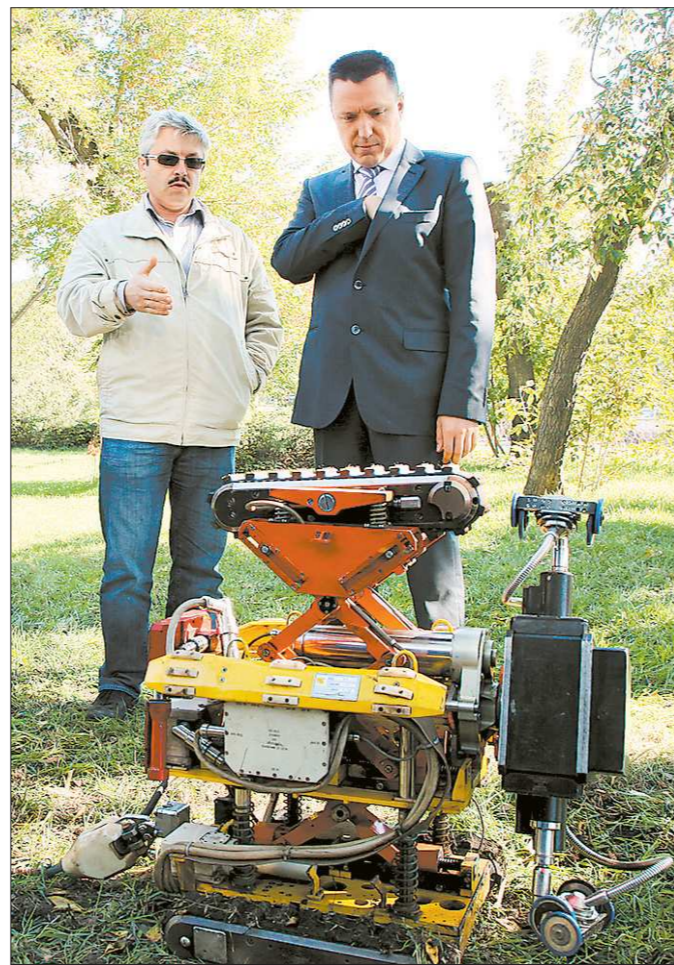
Этот робот-дефектоскоп, проходя внутри трубопроводов, объективно оценивает состояние труб
