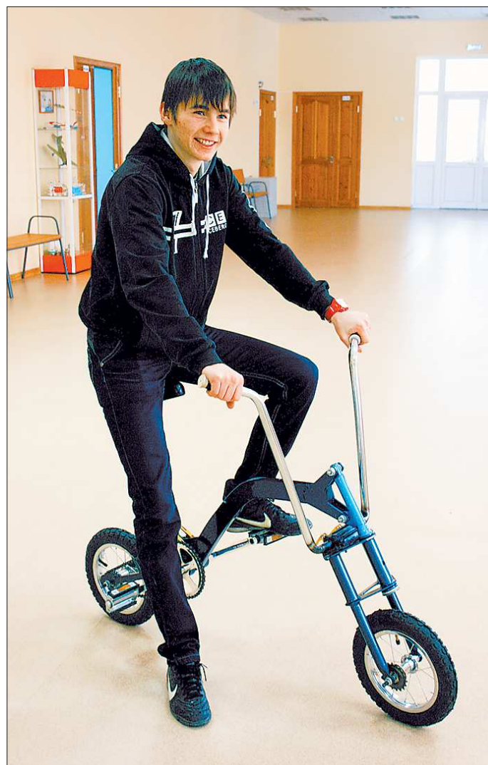
Свой велосипед Женя Шабалин собрал, в основном, из подручных средств, в том числе, из водопроводных труб, в школьной мастерской. Женя и научный руководитель проекта Владислав Толмачёв уже не раз испытывали велосипед в действии
