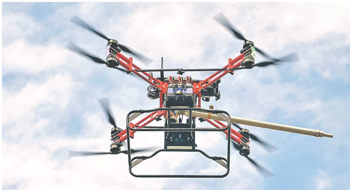
Дрон-пожарник «Грузовик М-500» поднимается на высоту до 100 метров и за несколько минут способен потушить небольшой очаг возгорания
