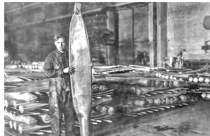
Первая партия штамповок лопастей для боевых самолетов в кузнечном цехе завода №268, 1943 год. Фото из книги «Трудовой подвиг Каменска-Уральского», автор-составитель О. Рыбакова, издательство ООО «Дизайн ввремя», 2025 г.
