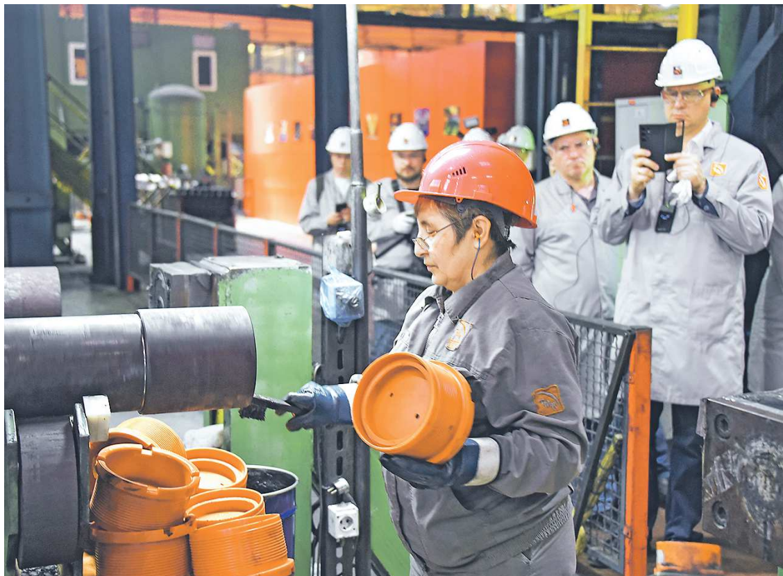
На готовую трубу обязательно надевают предохранитель, который защищает ее при транспортировке. Это делают вручную, чтобы не деформировать резьбу
