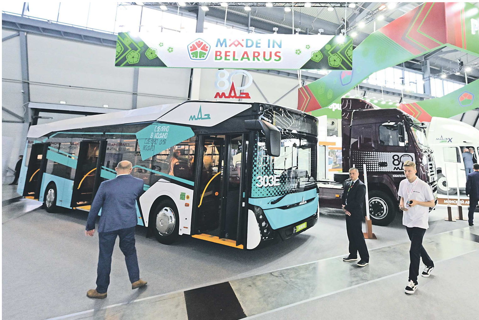
Электробус МАЗ-303 может проехать без подзарядки до 300 километров
