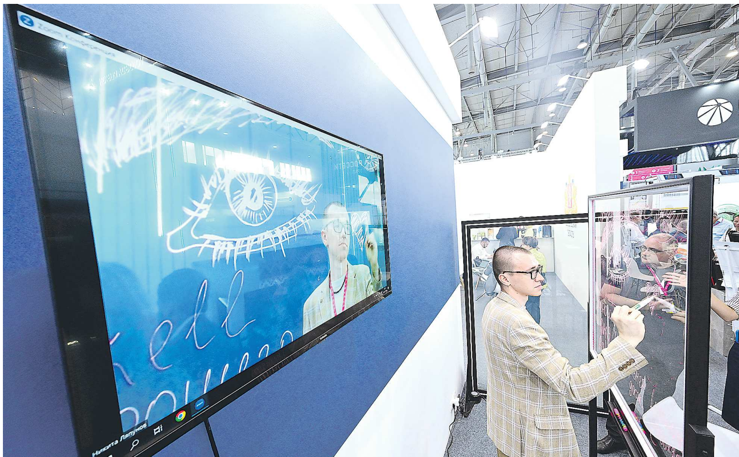
Прозрачные видеодоски компании «Аскел» подключаются к компьютеру, и все, что на них изображается, выводится на экран мониторов
