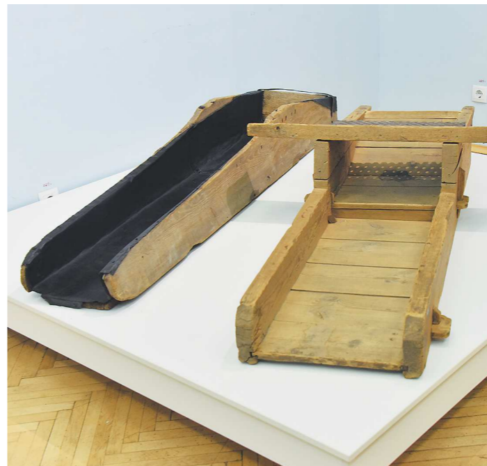
Специально для этой экспозиции из музейных фондов отреставрированы и впервые показаны инструменты золотодобытчиков. Например, вахгерд для промывки золотосодержащего песка
