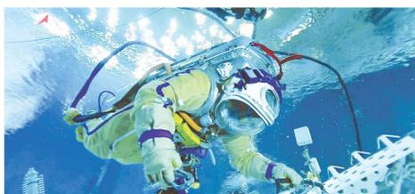
Гидроневетность – один из наиболее эффективных способов моделирования условий работы за пределами станции. Космонавт в скафандре погружается в воду и отрабатывает задания, которые затем придется выполнять в открытом космосе
