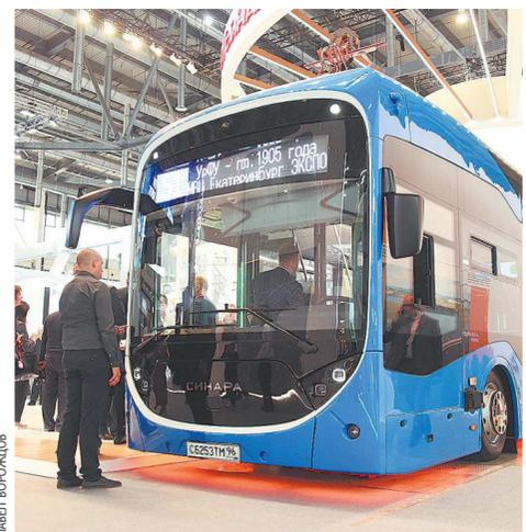
Группа Синара представила электробус, который проезжает 250 километров без подзарядки. Он совмещает два способа зарядки – ночную (в парке) и ультрабыструю (на конечных остановках)
