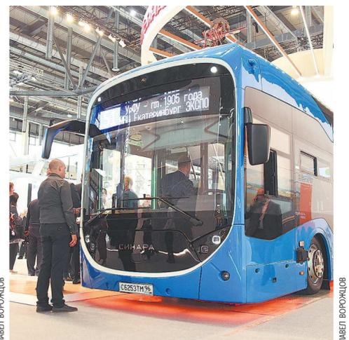
Группа Синара представила электробус, который проезжает 250 километров без подзарядки. Он совмещает два способа зарядки – ночную (в парке) и ультрабыструю (на конечных остановках)
