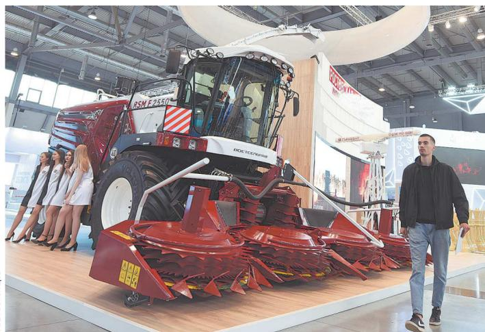
Такие флагманские кормоуборочные комбайны производят в Ростовской области. Их барабан с 48 ножами измельчает корма с грубым стеблем до заданных размеров. Машины уже работают на полях Талицкого, Ирбитского, Байкаловского районов Свердловской области. Раньше агрегат выпускали с двигателем Mercedes, теперь его заменит камазовский
