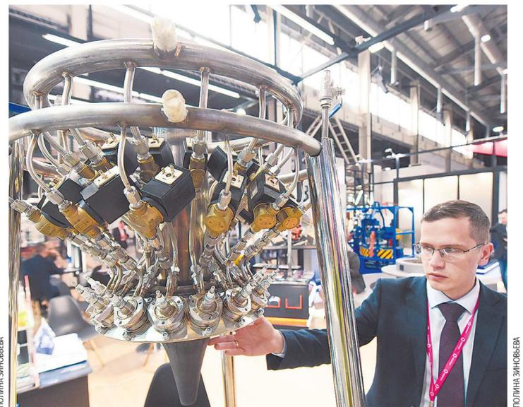
Смахивающая на дизайнерскую люстру установка – двигатель для «космической одноступенчатой ракеты – орбитальный носитель аппаратов», сокращенно «Корона». Предназначена эта совместная разработка ученых Южного и Среднего Урала для ракет многократного использования. Ее уже испытали в Нижней Салде на спиртовом топливе, теперь очередь за водородным
