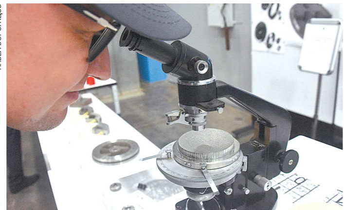
Ячейки в напечатанной детали можно разглядеть лишь в микроскоп
