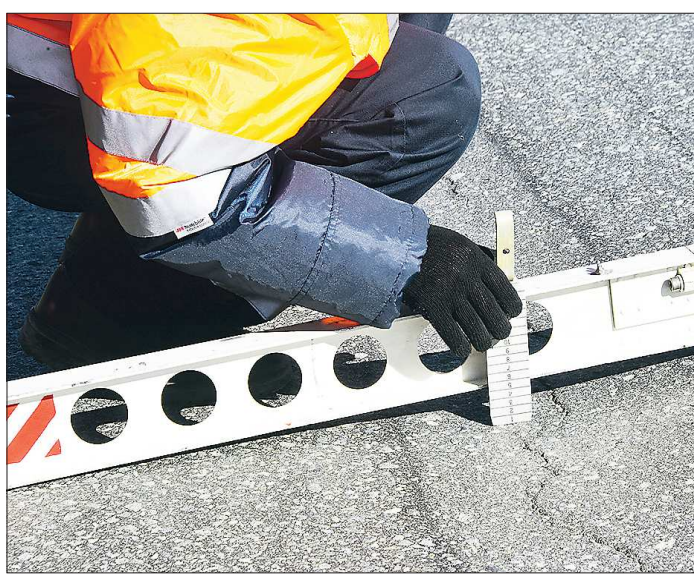
Глубокая колея на ещё не отремонтированном участке Режевского тракта создаёт угрозу возникновения ДТП
