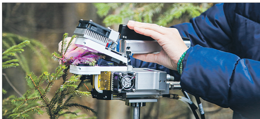
Процесс измерения поглощённого веточкой ели углекислого газа происходит вот в такой камере инфракрасного газоанализатора
