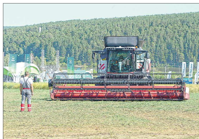
Обнаружив перед собой препятствие – механизатора – умный комбайн сразу останавливается
