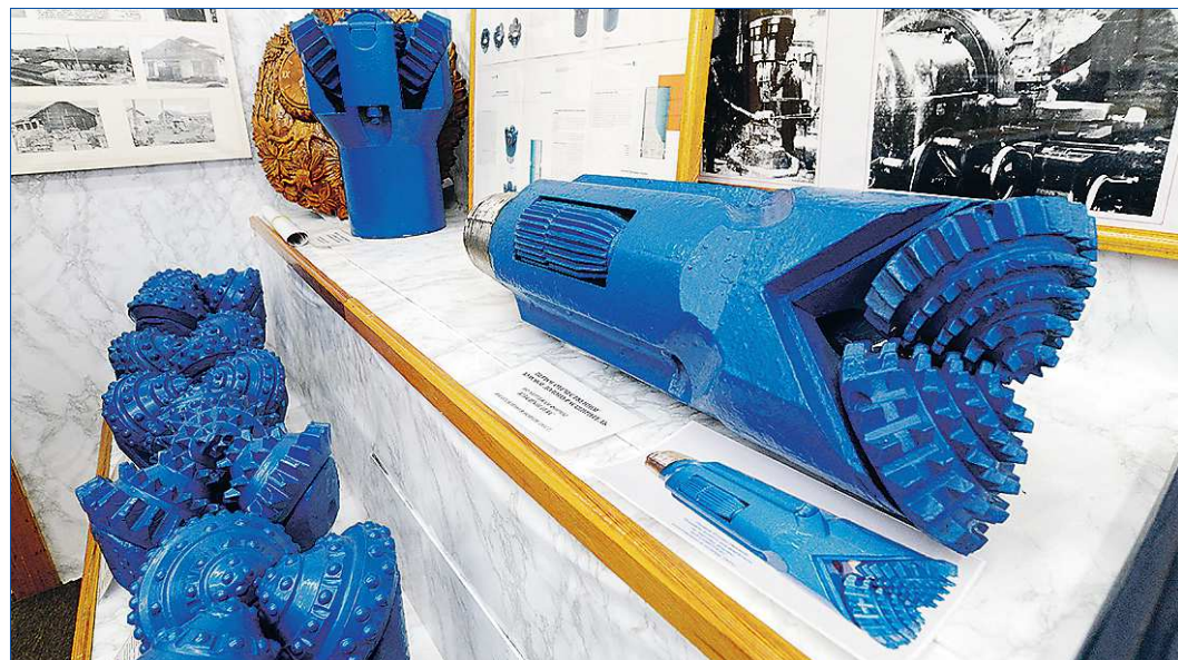
Первое отечественное долото-расширитель было сделано в Верхних Сергах в 1931 году по чертежам компании «Юз-Симплекс»
