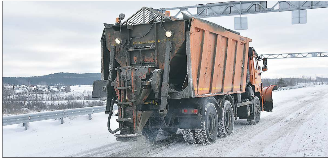
В дни снегопадов комбинированные дорожные машины, разбрасывая противогололёдные смеси, наматывают до 120 километров
