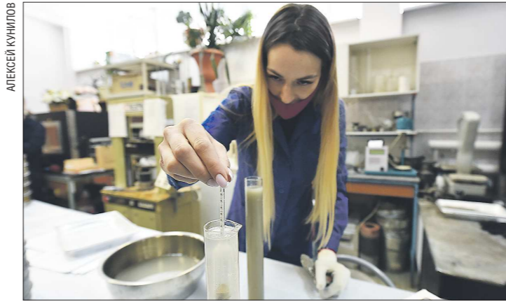
Лаборант управления автомобильных дорог Наталья Макарова проводит экспертизу противогололёдной смеси
