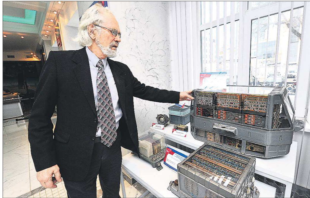
Лев Бельский показывает первую в СССР бортовую цифровую вычислительную машину ЦВМ-1. Компьютеры для ракет семейства «Союз-2» в несколько раз меньше по массе и габаритам
