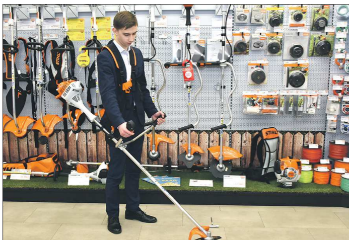
Как видим, триммеры есть в широком ассортименте: с двигателем внизу (нельзя косить мокрую траву) и с двигателем сверху (низкими ограничениями)
