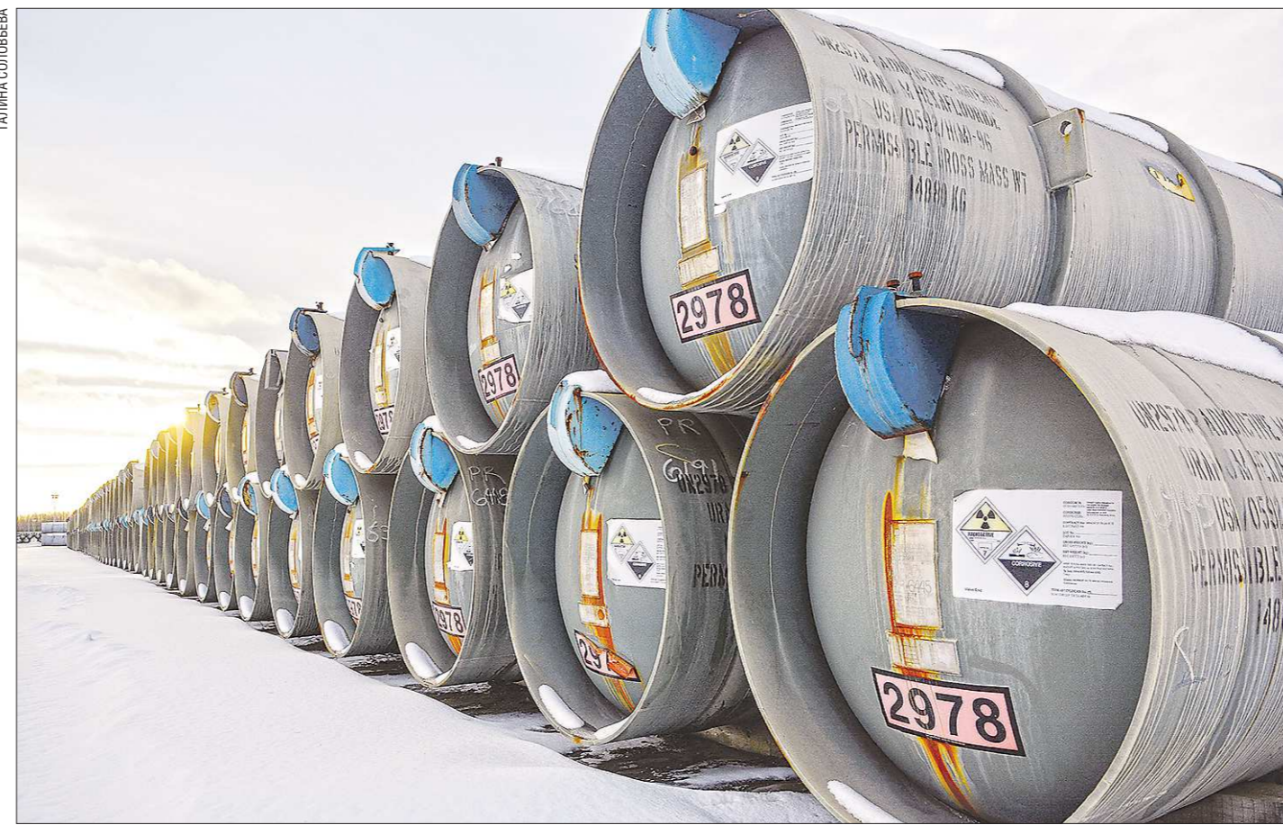
Контейнеры, в которых транспортируется и хранится обеднённый уран, изготовлены из углеродистой стали, толщина стенок - 13-15 мм. В соответствии со стандартами МАГАТЭ, предусмотрена защита при нагревании до 800°C. Разрушить такую защиту переносимыми средствами невозможно
