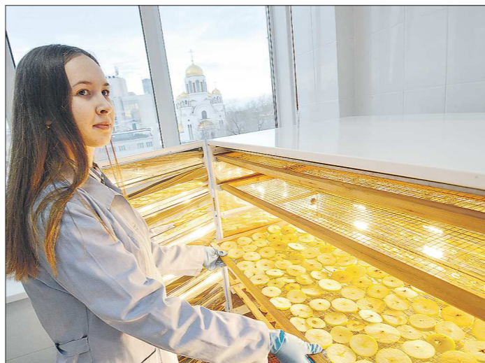
Инфракрасная сушилка, разработанная уральскими и крымскими учёными, может за раз вмещать несколько килограммов фруктов или овощей
