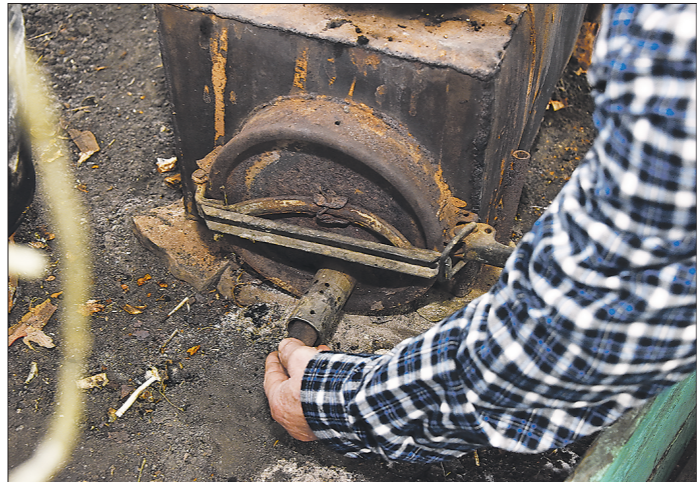
Регулируемое круглое поддувало – секрет печи, что греет теплицу с помидорами
