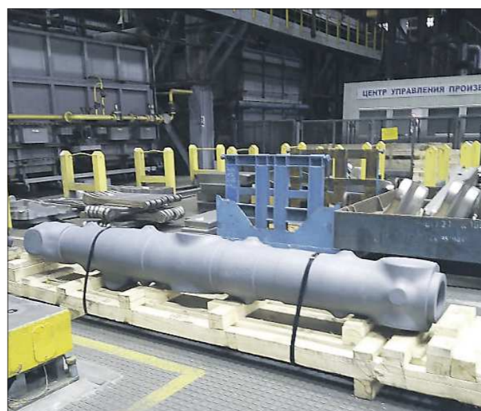
Так выглядит элемент стойки шасси самолёта. Такие ВСМПО отправляет и зарубежным, и отечественным покупателям
